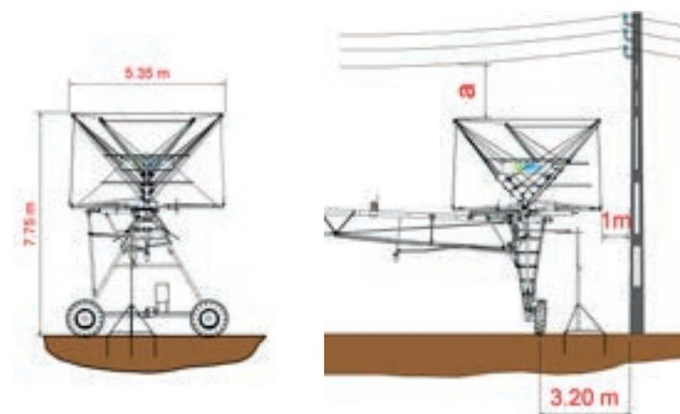
В случае перемещений под линиями электропередач, следует обратиться к поставщику электроэнергии, чтобы определить минимальное расстояние «А», которое следует соблюдать под проводами.
