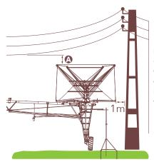
No caso de passar por uma linha elétrica, aproxime-se da fonte de energia elétrica para determinar a distância mínima (A) a ser observada sob os cabos.
