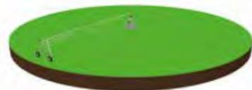
Le point pivot constitue le centre du disque irrigué. Sa fonction est de garder les travées centrées dans la parcelle. Pour cela, il doit résister à deux forces principales : une force de traction des travées en mouvement et le poids de la première travée. Au-delà de la résistance individuelle de chacun des éléments constitutifs de l'unité centrale, c'est la résistance structurelle globale
