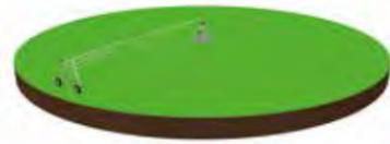
La Unidad Central del pívor es el centro del disco irrigado. Su función es mantener los tramos centrados en la parcela. Para ello, debe resistir dos fuerzas principales: una fuerza de tracción de los tramos en movimiento y el peso del primer tramo. Mas allá de la resistencia de cada uno de los elementos constitutivos de la unidad central es la
